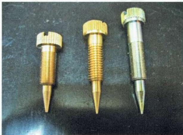
左より、SOLEX（3/4型）、WEBER、OERの順に並んでおります。ご覧になってわかるようにスクリューのネジピッチも細かく、先端の角度も最も鋭角な設計になっております。これは、キャブのアイドルリング時の燃料調整を細かくセッティング出来るよう設計されたものです。
